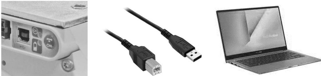
*Figure 1 - Branchement de la prise USB-B au port situé à l'arrière de la roue
